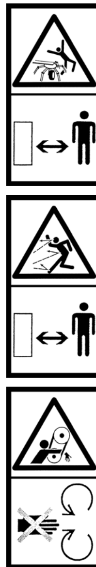
Rys 2. Znak informujący o zagrożeniu wciągnięcia nóg lub innych części ciała przez wirujące elementy oraz o sposobie uniknięcia zagrożenia przez zachowanie bezpiecznej odległości od maszyny (umieszczony na osłonie głównej przekładni pasowej).
