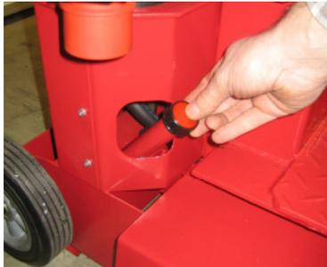
**Achtung! Hydraulikölstand nur bei eingefahrener Spaltsäule prüfen.**
