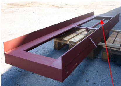
Ramme til nedstøbning. rør til kabler
